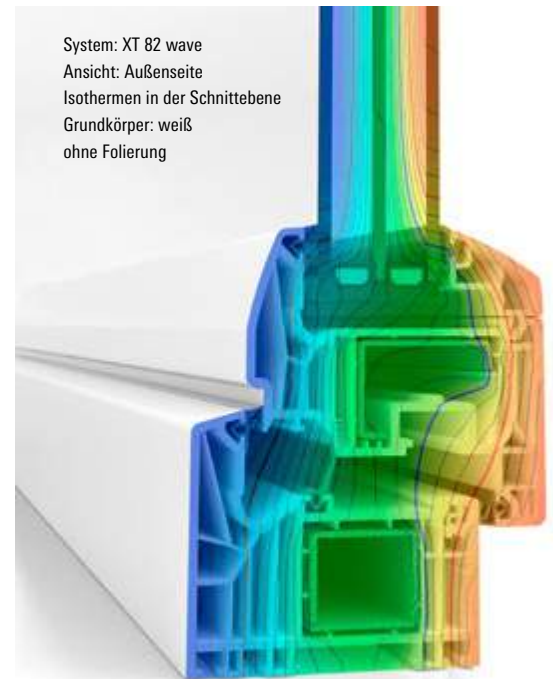
Parameter der dargestellten Isothermen: T_a = -5^\circ\text{C} , T_i bei 20^\circ\text{C} und 50 % relative Luftfeuchte, Linie rot: 13^\circ\text{C} , Linie blau: 10^\circ\text{C} , Linie Schwarz: 0^\circ\text{C} . Quelle: Schüco
